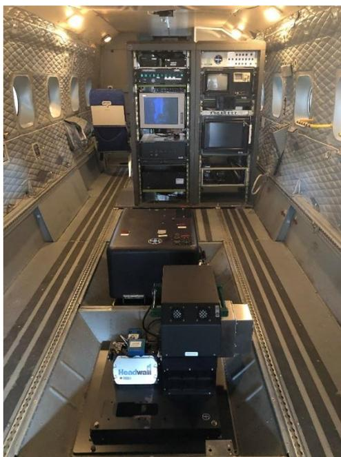
Figura 3 . AHS instalado en la ventana inferior delantera del avión, junto con sus módulos de control y registro en rack vertical
