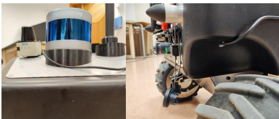
Figura 1. Sensor LiDAR y soporte instalados
