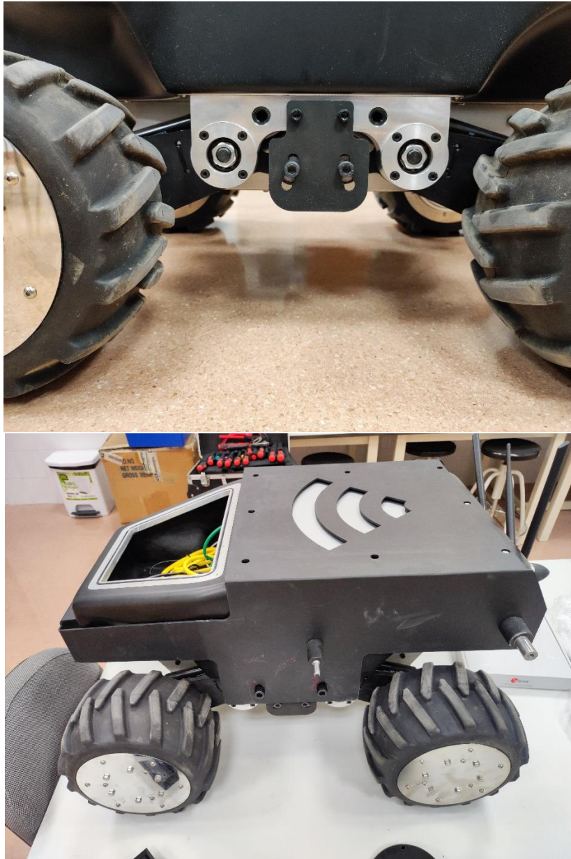
Figura 6. Fijación de la carcasa al chasis del robot (arriba) y vista general del robot con carcasa (abajo)
