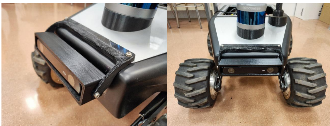
Figura 5. Acople de la cámara estereoscópica al robot
