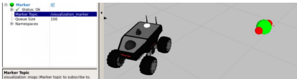
Figura 5. Representación en Rviz de la detección de una persona
